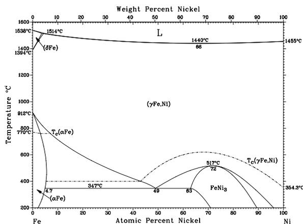
Fig. 6 Fe Ni phase diagram
