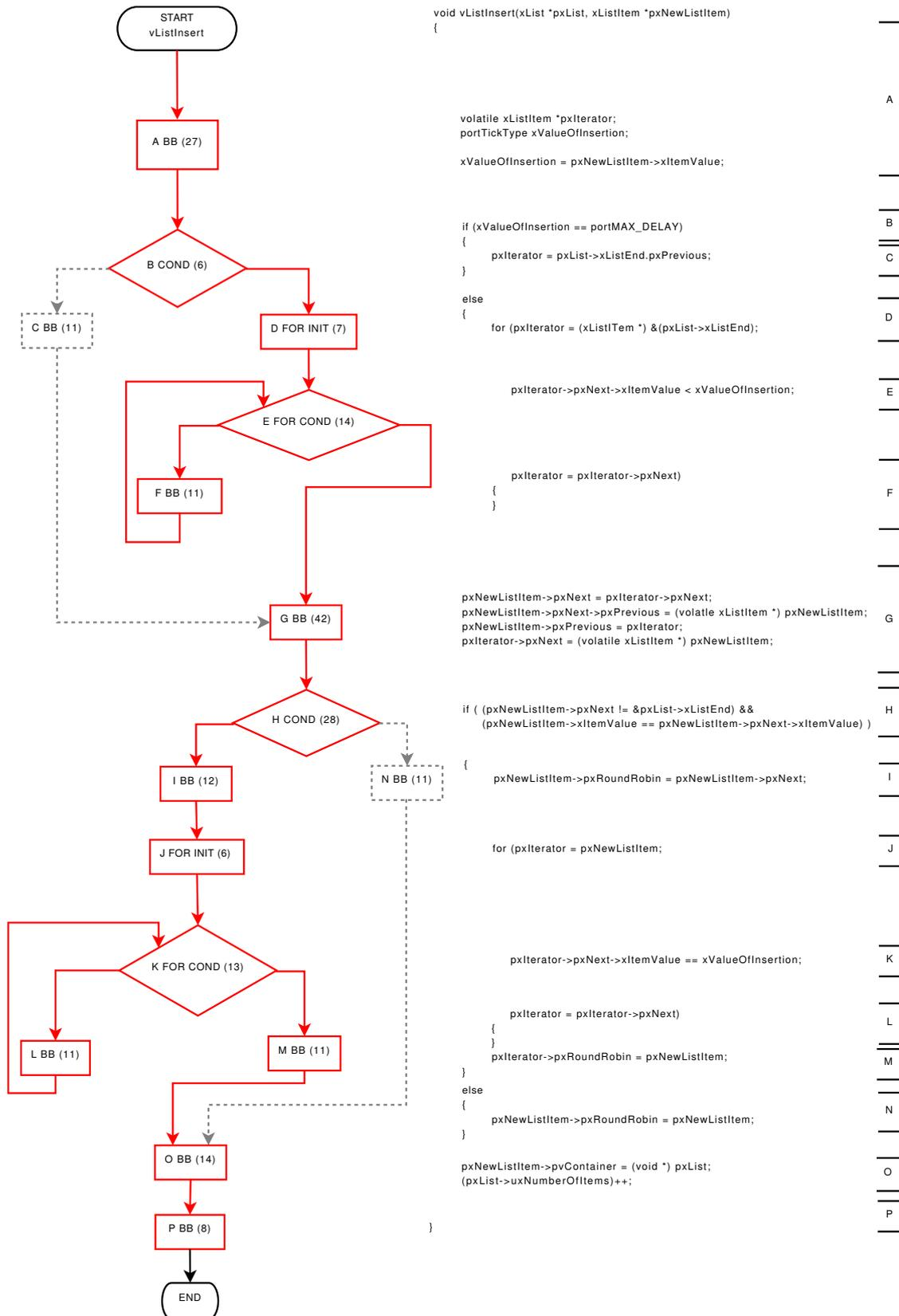
Fig. 3 CFG of vListInsert function
