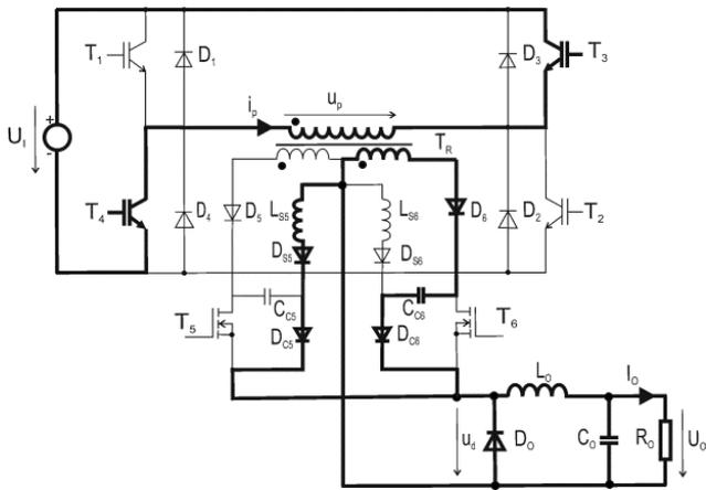
Fig. 3c Operation in interval  $t'_{32} - t'_{33}$
