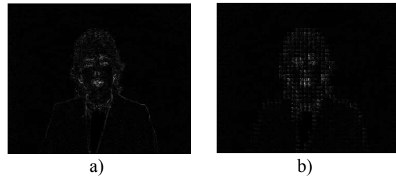
Obr. 4 a) Vybraná snímka diferenčnej videosekvencie „Claire“ b) jej transformovaný obraz
